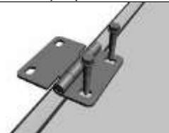
**5. Установка на нижнюю панель боковых опор с роликами**
