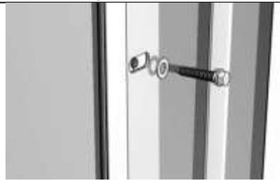
По панели установить вертикальные направляющие и закрепить угловые стойки к стене.
